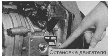
Рис. 8. Рычажный механизм управления двигателем
