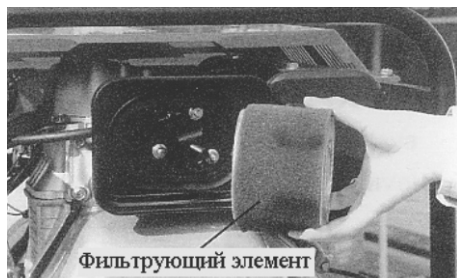
Рис.11. Обслуживание воздушного фильтра
